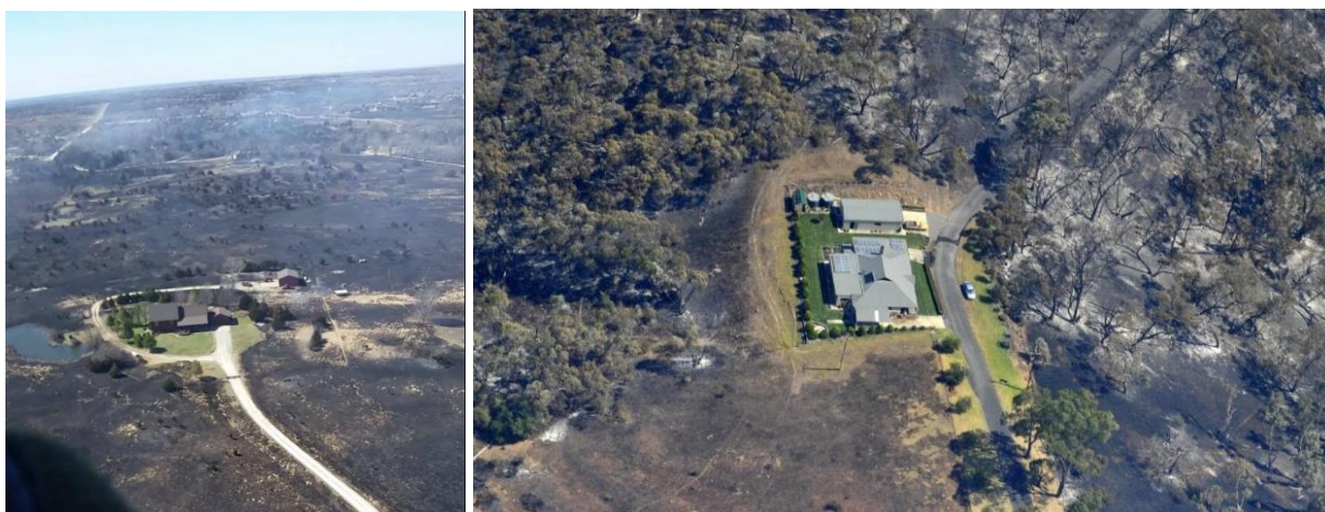
Figura 5.3 – Esempi di abitazioni con spazi difensivi che hanno resistito agli impatti di grandi incendi boschivi.
